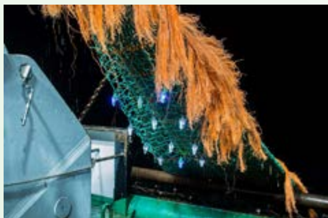
Afbeelding 1: licht in een paneel in de rug van het net
